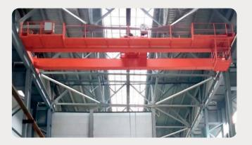
Кран мостовой двухбалочный грузоподъемностью 20,0 тонн для предприятия в Красноярском крае.
