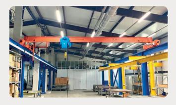
Кран мостовой опорный однобалочный грузоподъемностью 6,3 тонны для предприятия в Копейске.
